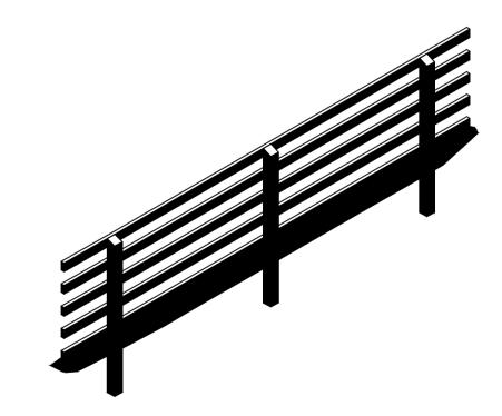
TIMBER POST & RAIL FENCING - ISOMETRIC VIEW
